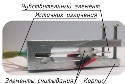
Рисунок 7 – Макет преобразователя линейного ускорения с оптическим считыванием
