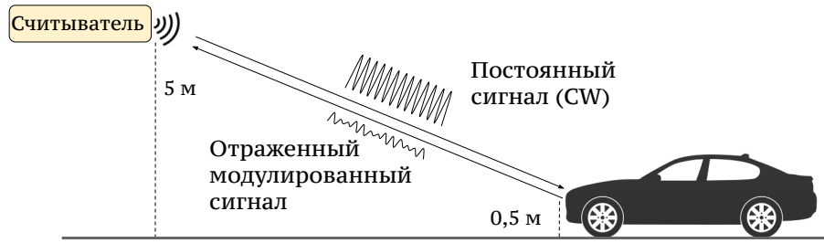
Рисунок 2.1 — Структура системы радиочастотной идентификации автомобилей
