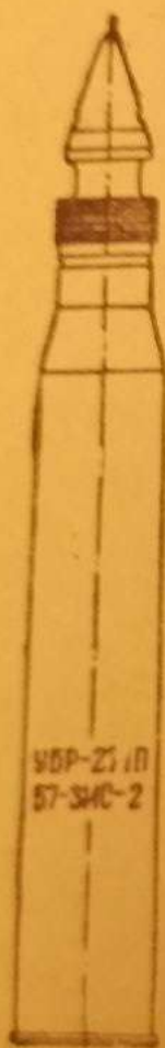
Унитарный патрон с подкалиберным бронейбойно-трассирующим снарядом
