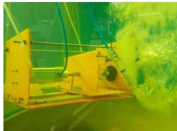
Испытания на сдвиг вакуумной присоски в водной среде
