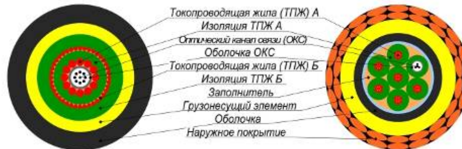
Строение коаксиального кабеля нейтральной (переменной) плавучести. Предлагается использовать в перспективе.
