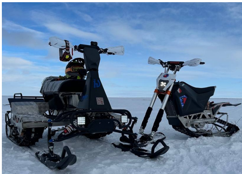
Рис. 1. Опытные образцы малогабаритных транспортных средств повышенной проходимости на электроприводе, предназначенные для передвижения по снежному покрову – двухколейный «утилитарный снегоход и одноколейный «снегоцикл».
