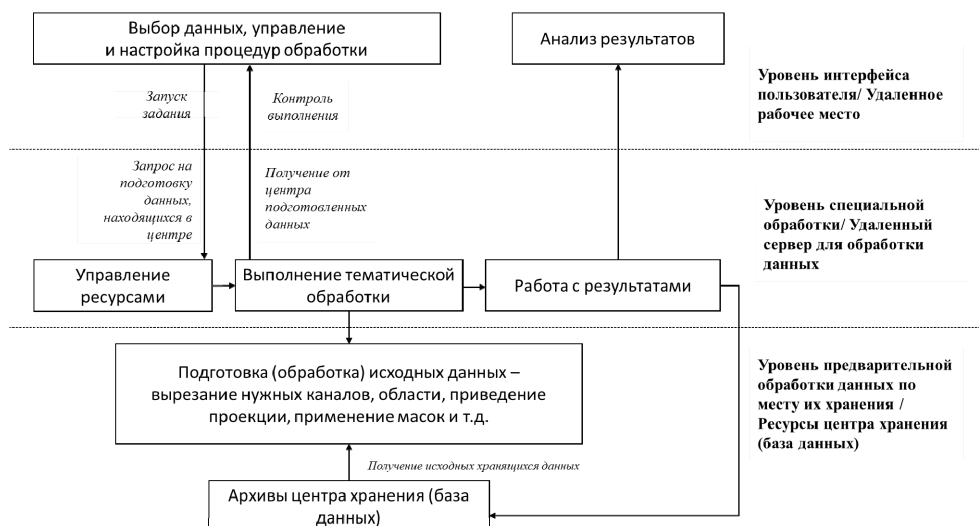
Рис. 1. Схема процесса, направленного на разделение вычислительной мощности при обработке мультиспектральных снимков.
