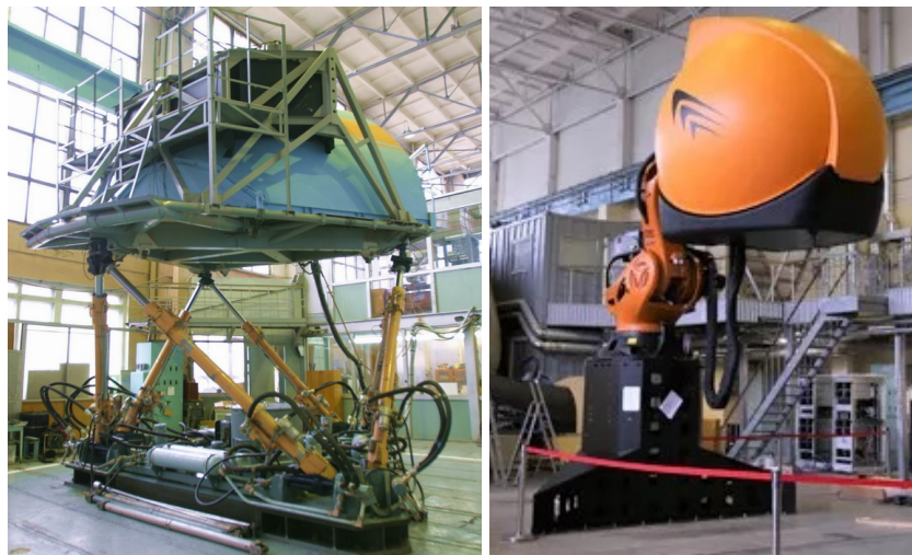
Рис. 1. Пилотажный стенд (слева – а) с подвижной кабиной (ПСПК-102 ЦАГИ) на базе платформы Стюарта и тренажер пространственной дезориентации (справа – б) на базе промышленного робота KUKA KR 1000 Titan.
