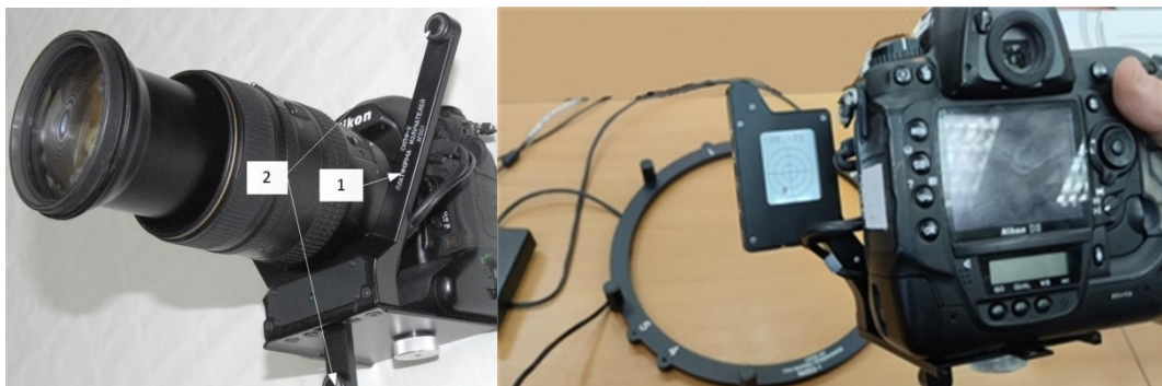
Рис. 1. Фотокамера с аппаратурой СКПФ-У. Слева: 1 – установленная на фотокамеру платформа с; 2 – ультразвуковые излучатели, размещенные на платформе. Справа: платформа с ультразвуковыми приемниками, устанавливаемая на иллюминатор.
