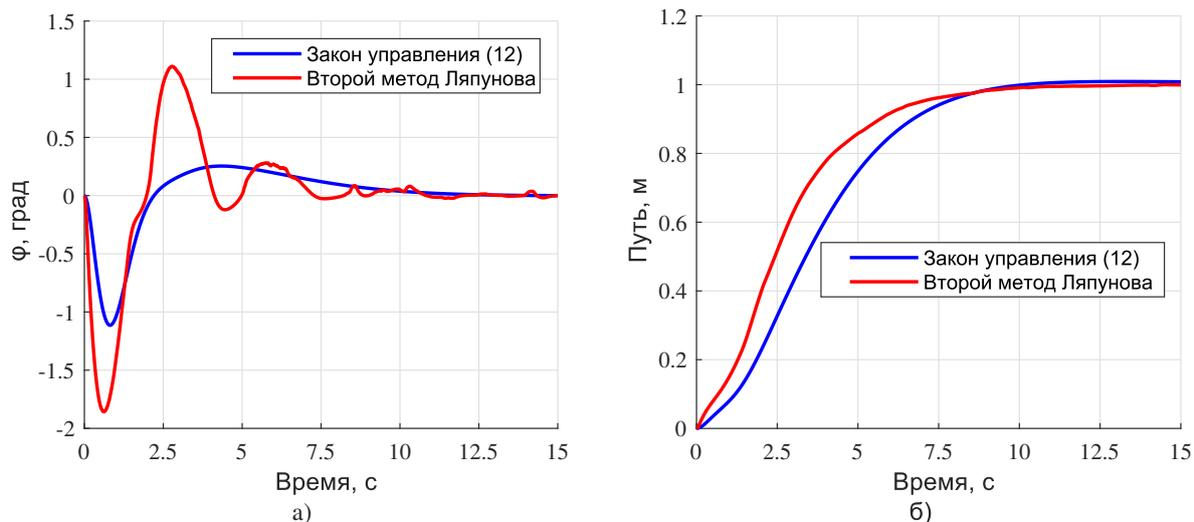
Рис. 2. Результаты численного моделирования (а - угол отклонения груза от вертикали, б - пройденный путь тележки)
