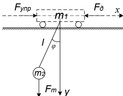
Рис. 1. Схема системы тележка-маятник
