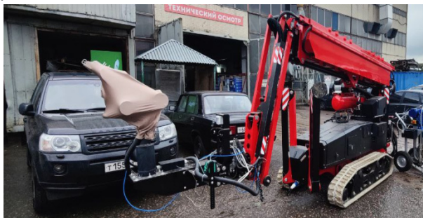
Рис. 6. Робототехнический комплекс на тестах в реальных условиях. Тестирование проводилось на открытом воздухе с ЛКМ для окраски поверхностей судов.
