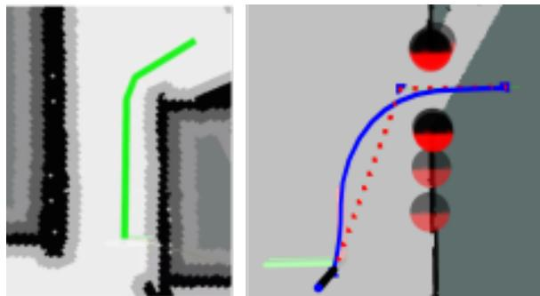
Рис. 1. Раздутье препятствий при локальном планировании (слева) и локальная траектория робота через проем в сравнении с глобальным путем (справа)
