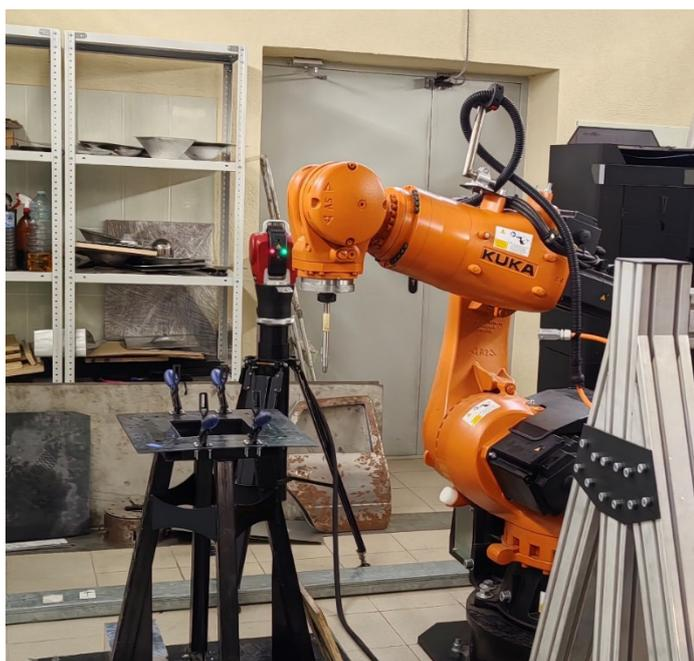
**Рис. 3.** Общий вид экспериментальной установки для отработки системы компенсации отклонений инструментального центра робота-манипулятора от заданной траектории.
