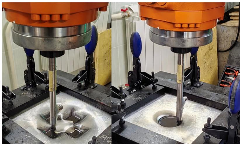
**Рис. 4.** Выполнение сложной (слева) и криволинейной (справа) тестовых траекторий.
