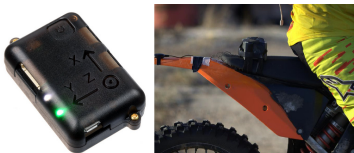
Рис. 1. Модуль навигации NGIMU, закрепленный на мотоцикле.
