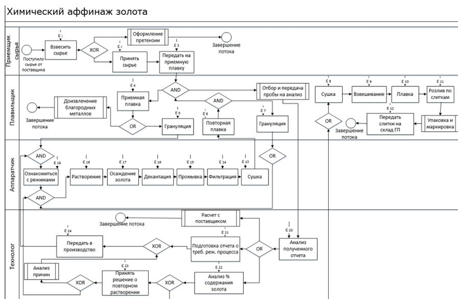
Рис. 2. Модель имитации технологии.
