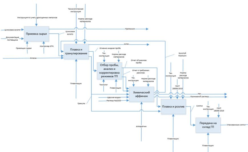
**Рис. 1.** Диаграмма декомпозиции процесса «Химический аффинаж золота» в нотации IDEF0.
