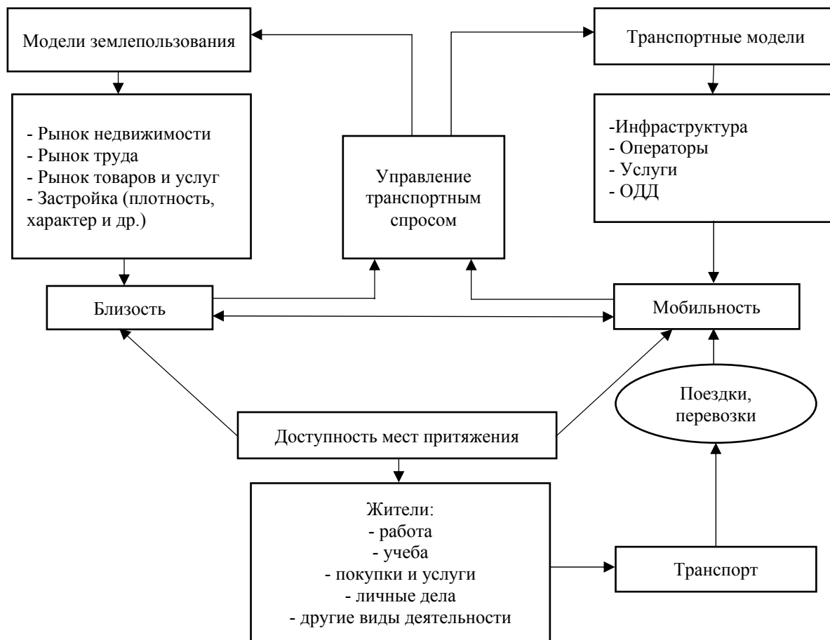
Рис. 2. Общая схема совместного моделирования землепользования и транспорта.
