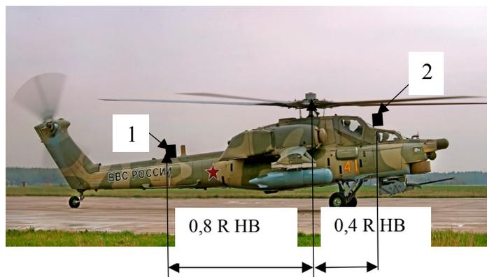
**Рис. 4.** Расположение ПВС на балке и на кабине пилотов. 1 – датчик ПВС индуктивной скорости  $V_{и1}$ ; 2 – датчик ПВС индуктивной скорости  $V_{и2}$  по данным [7].
