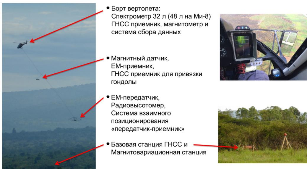
**Рис. 1.** Компоновка аэрогеофизического комплекса ЭКВАТОР. ЕМ-приемник/передатчик – электромагнитный приемник/передатчик.
