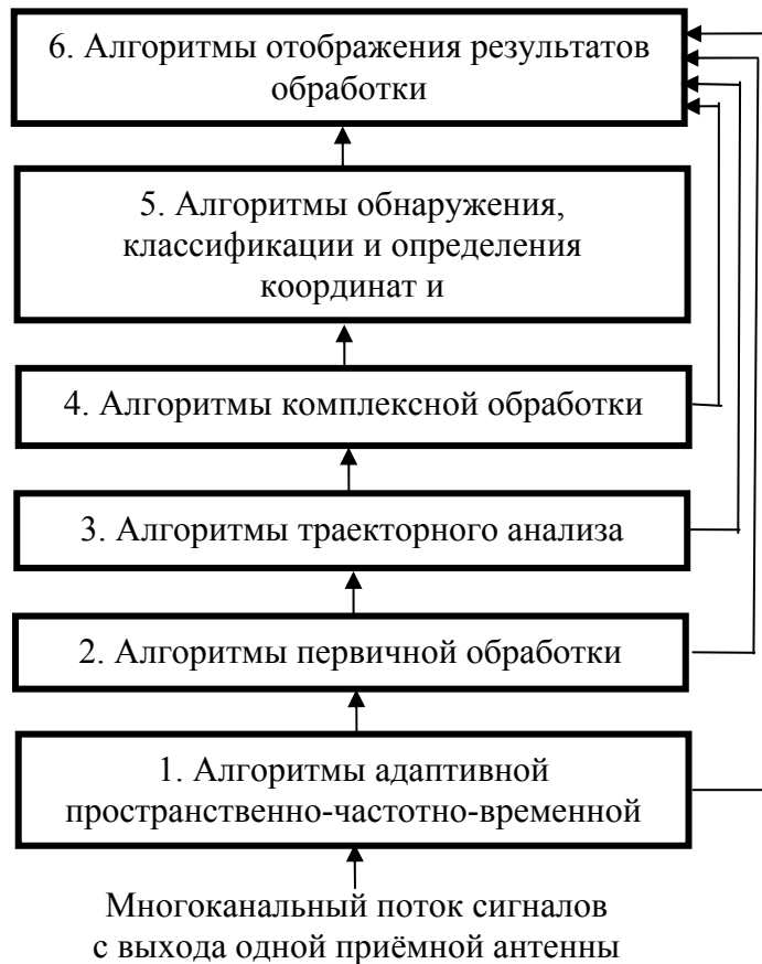
Рис. 2. Алгоритмическая структура обработки сигналов с выхода одной приёмной антенны ГАК ПЛ в одном из режимов работы.
