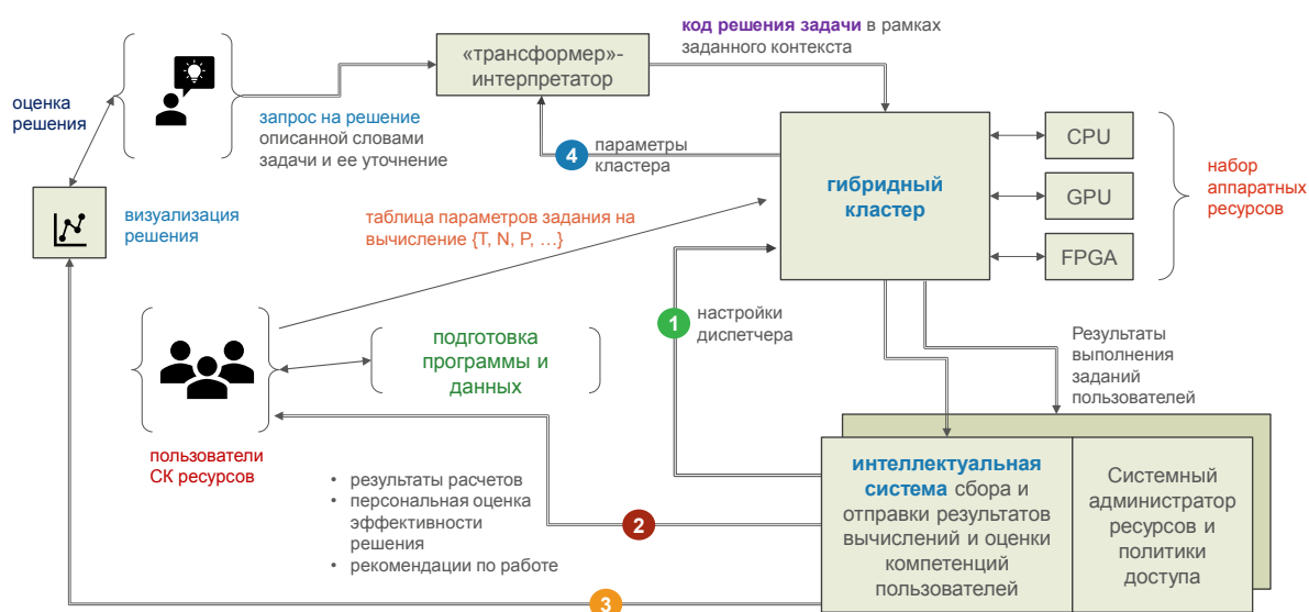
Рис. 3. Двухконтурная система управления потоком запросов СКЦ «Политехнический».
