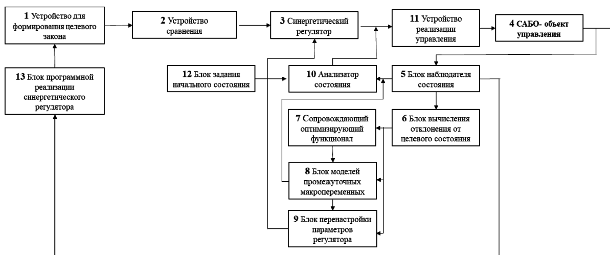
Рис. 3. Схема СТУ-управления переходами САБО от одного макросостояния к другому.
