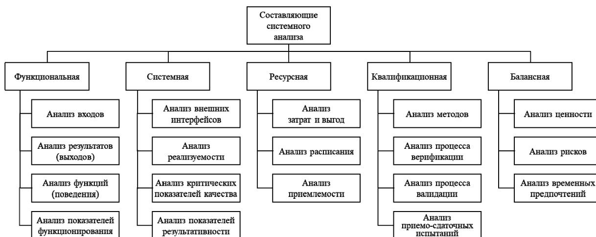
Рис. 1. Составляющие системного анализа в процессе системной инженерии.
