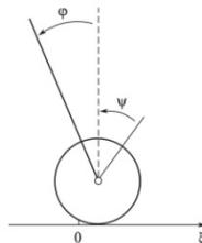
Рис. 1. Схема маятника на колесе.
